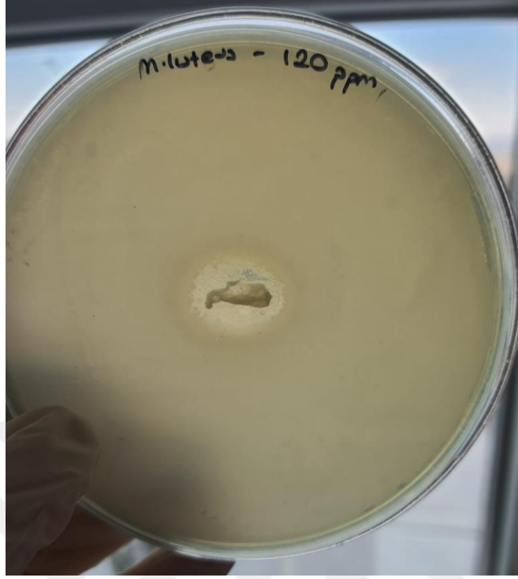
Şekil 4.15. 120 ppm \text{CuSO}_4 \cdot 5\text{H}_2\text{O} 'da hazırlan fiberlerin Micrococcus luteus bakterisine karşı gösterdiği antibakteriyel etkinlik
