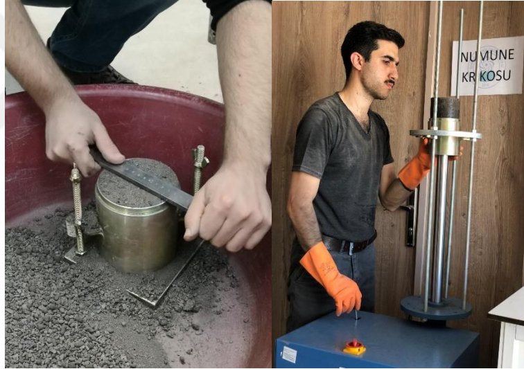
Şekil 4.13 : Sıkıştırılan numunenin tıraşlanma ve kalıptan çıkarılma işlemleri.
