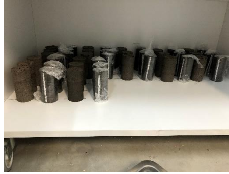
Şekil 4.19 : Numunelerin açık ortam, streçe sarılı olarak bekletilmesi.
