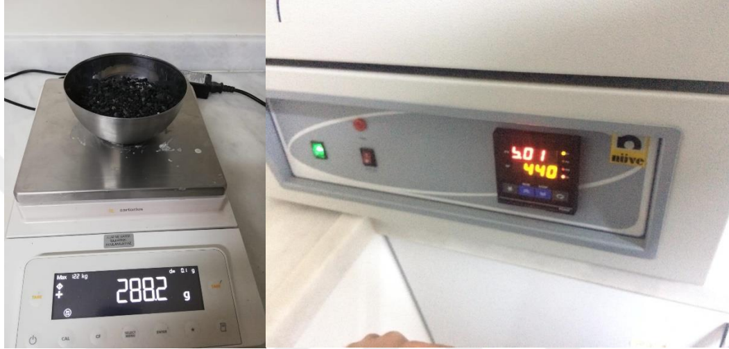
Şekil 4.2 : Kütle ölçümü ve etüv sıcaklığı.
