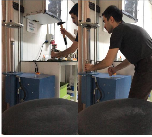
Şekil 4.18 : Numunenin sıkıştırılması ve kriko yardımıyla molddan çıkarılması işlemi.
