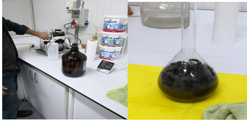
Şekil 4.3 : Vakum yardımı ile hava alma işlemleri.
