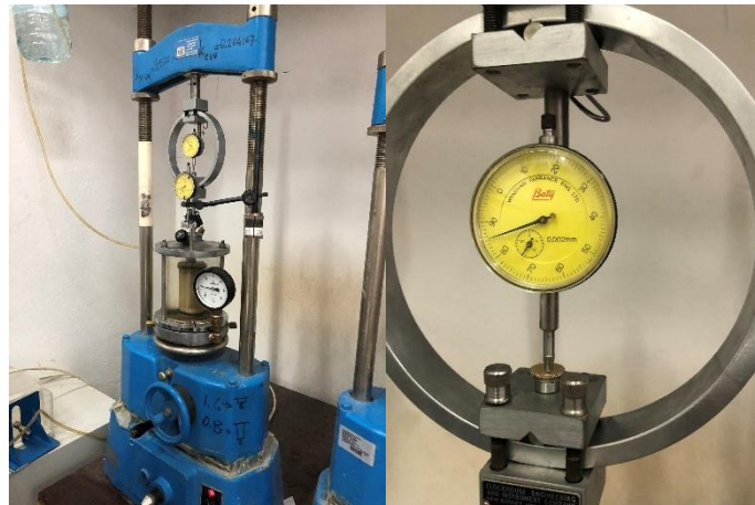
Şekil 4.28 : Üç eksenli basınç deneylerinde kullanılan cihaz ve yükleme halkası.
