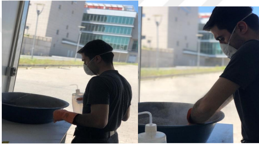
Şekil 4.11 : Numunenin homojen olarak karıştırılma işlemi.
