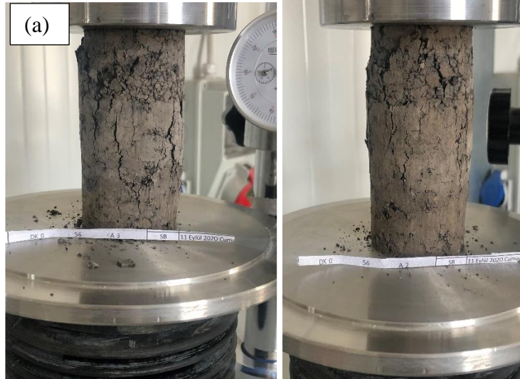
Şekil 4.21 : Serbest basınç dayanımı testlerinin yapılması.
