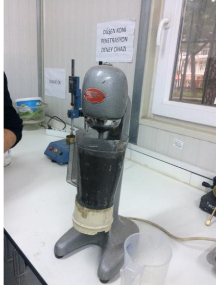
Şekil 4.5 : Solüsyon içinde 24 saat bekleyen numunenin mikser yardımı ile karıştırılması.
