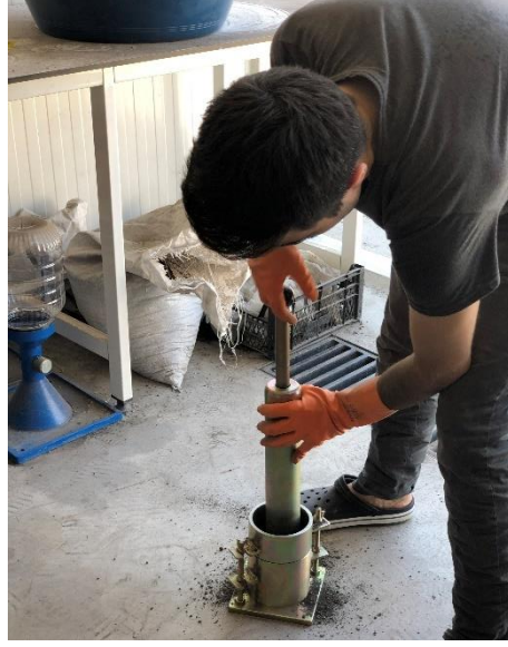
Şekil 4.12 : Organik zeminin sıkıştırılması işlemi.
