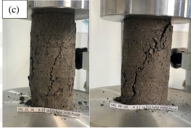
Şekil 4.24 : Süper Beyaz Çimento ile stabilize edilmiş zeminin gösterdiği 45° derecelik kırılma açısı.
