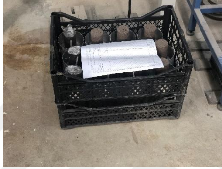
Şekil 4.27 : 28 ve 56 günlük numelerin açık ve kapalı kür koşullarında bekletilmesi.
