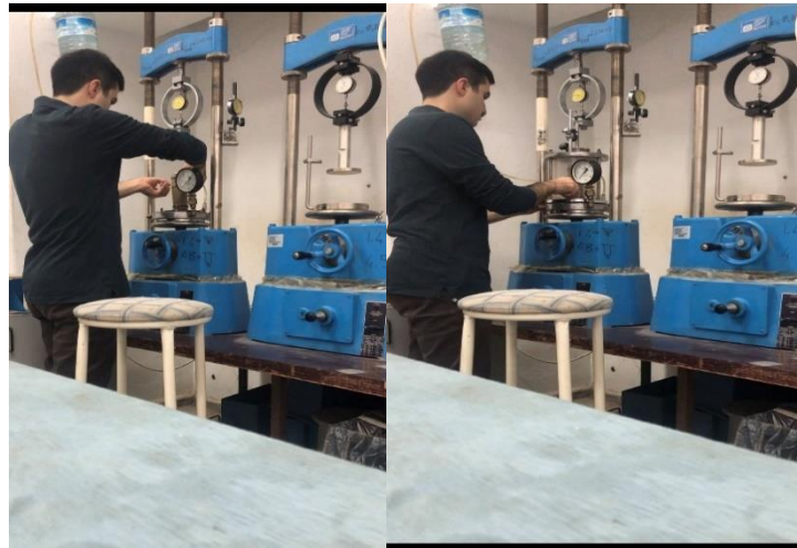
Şekil 4.29 : Numunenin cihaza yerleştirilmesi ve hücrenin takılması.
