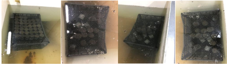
Şekil 4.20 : Kür havuzunda bekletilen numunelerin parçalanması.
