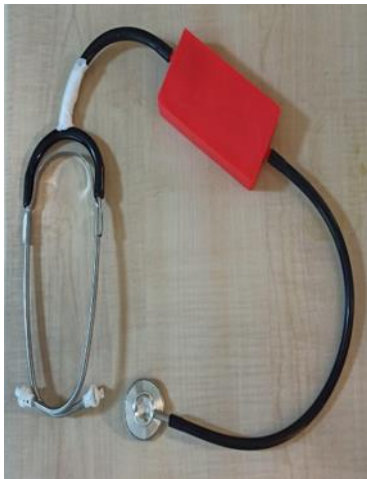
Şekil 3.7. Kablosuz Stetoskop Tasarımı
