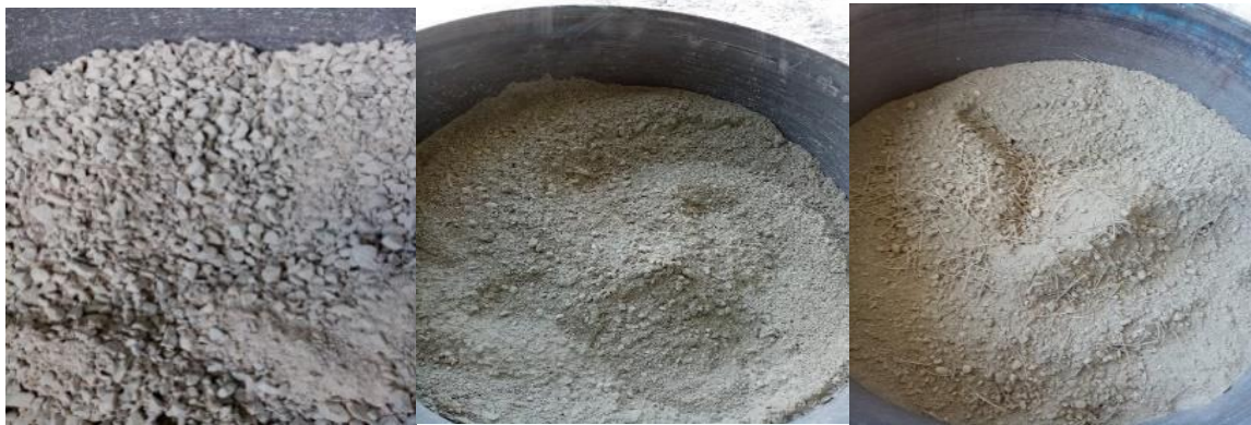
Şekil 3. 3. İri agrega (a), iri ve ince agrega karışımı (b), İri ve ince agreganın Lif ile karışımı (c)
