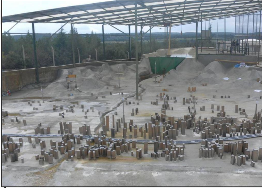
Şekil 3.1 Ürkmez Barajı Göl, Gövde ve Mansap bölgesi çarpıtılmış fiziksel modelinin bitki örtüsüz görüntüsü (TÜBİTAK 110M240, 2013)
