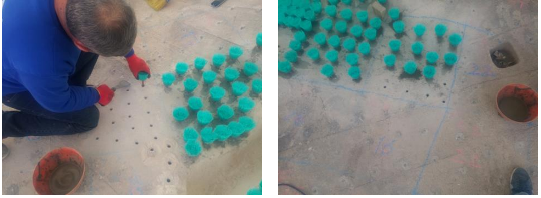
Şekil 3.4 Fiziksel modelde baraj mansabına temsili bitki örtüsünün yerleştirilmesi (TÜBİTAK 116M237, 2019)
