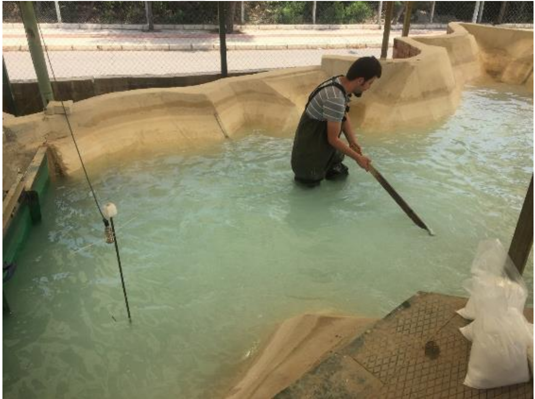
Şekil 4.3 Deney öncesi baraj gölüne kaolin kilinin karıştırılması (TÜBİTAK 116M237, 2019)
