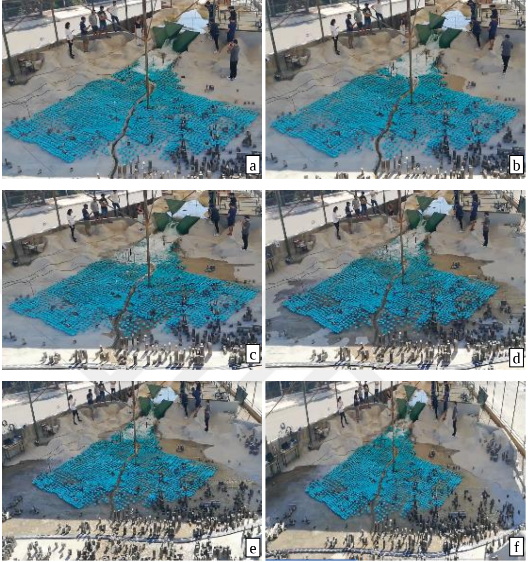
Şekil 4.66 Üçgen gedik yıkılma durumunda baraj gölünde su derinliği 88 cm iken gerçekleştirilen deney için kapak açıldıktan a) 3 saniye b) 6 saniye c) 10 saniye d) 15 saniye e) 25 saniye f) 35 saniye sonra alınan görüntüler (TÜBİTAK 116M237, 2019)
