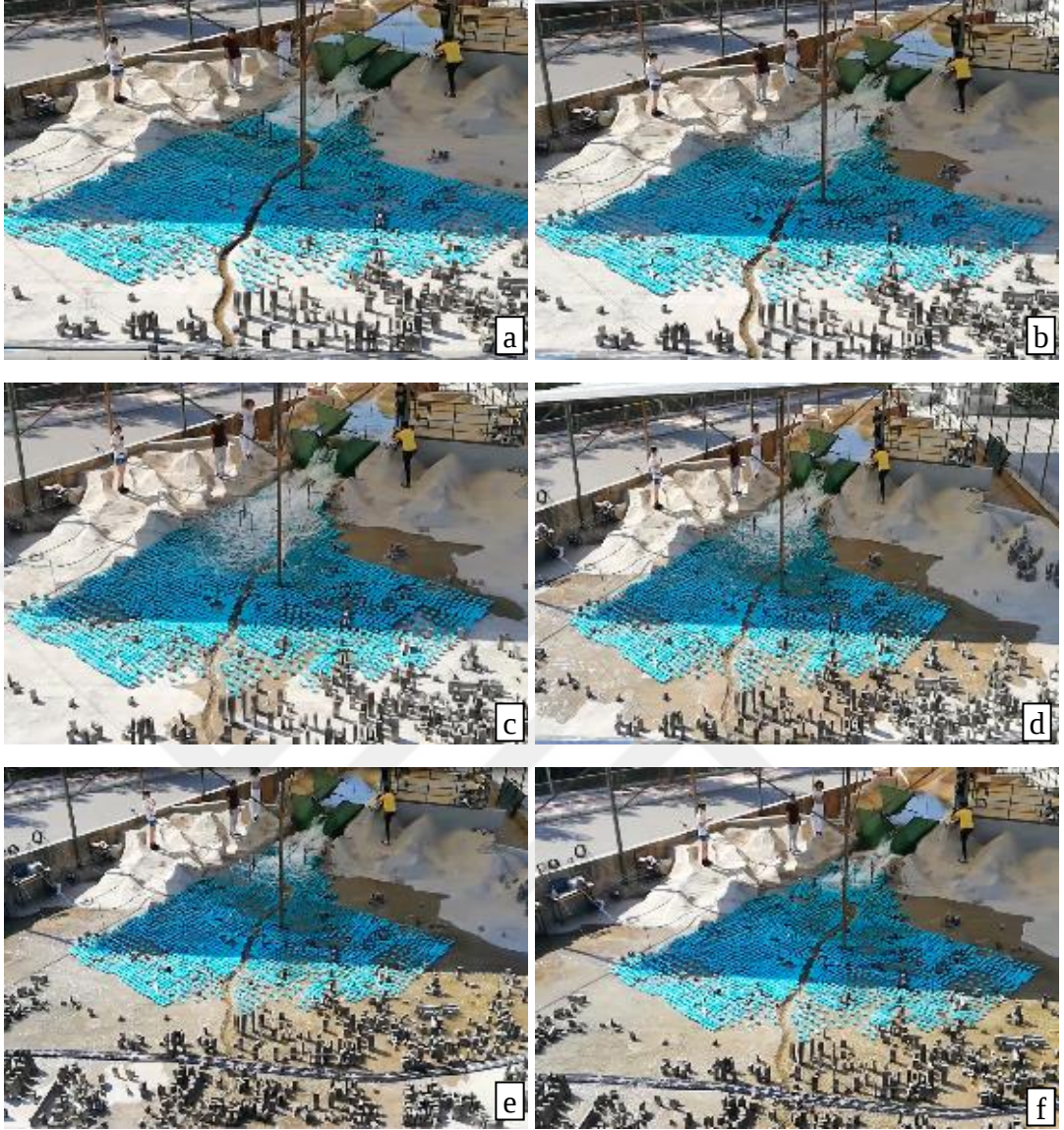
Şekil 4.65 Üçgen gedik yıkılma durumunda baraj gölünde su derinliği 98 cm iken gerçekleştirilen deney için kapak açıldıktan a) 3 saniye b) 6 saniye c) 10 saniye d) 15 saniye e) 25 saniye f) 35 saniye sonra alınan görüntüler (TÜBİTAK 116M237, 2019)
