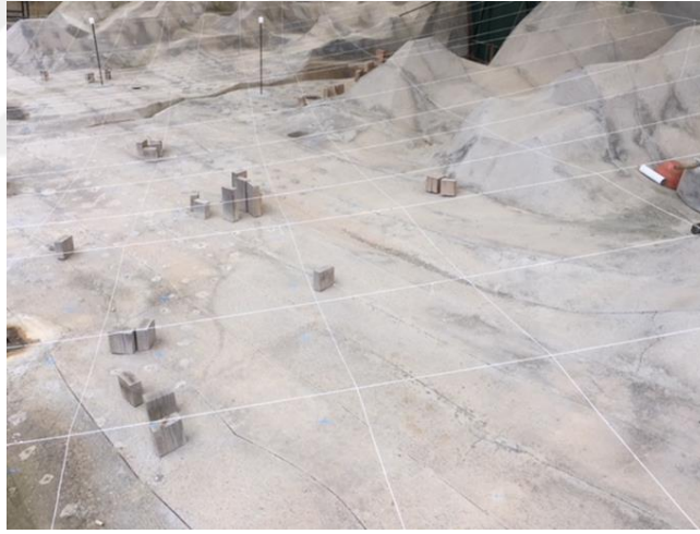
Şekil 3.3 Sayısal ızgara altlığı ve fiziksel modelde oluşturulan 50*50 cm boyutlarında kareler (TÜBİTAK 116M237, 2019)
