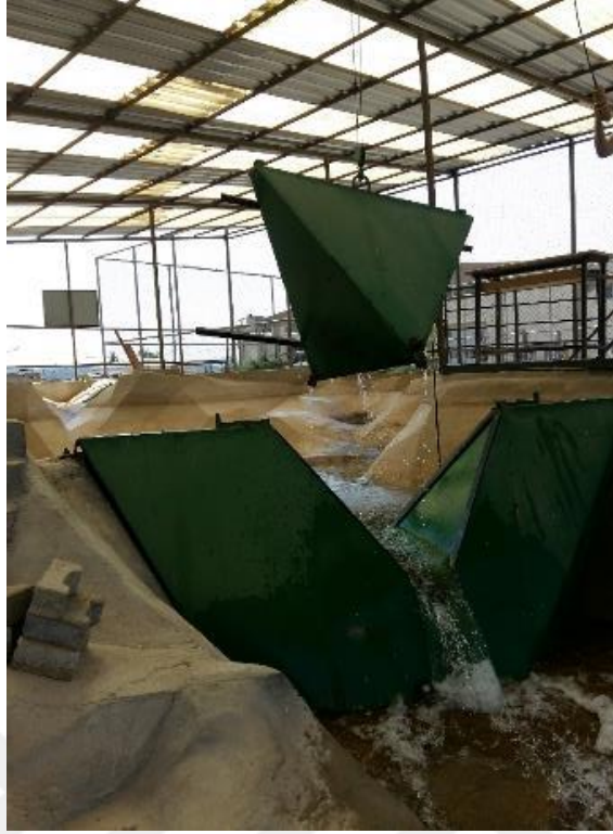
Şekil 4.48 Deney esnasında baraj gövdesinden ayrılmış durumdaki üçgen gedik görüntüsü (TÜBİTAK 116M237, 2019)
