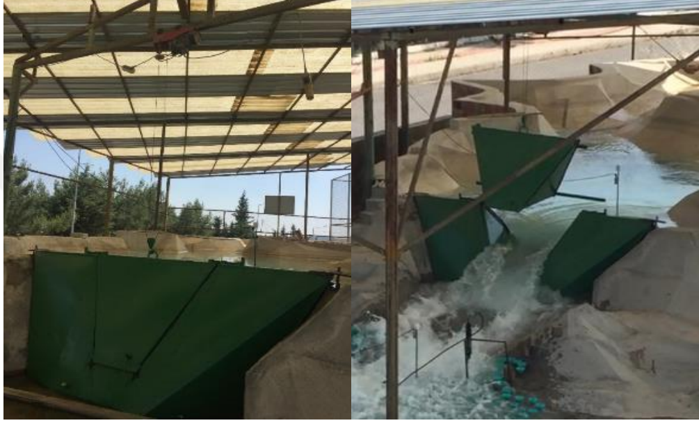
Şekil 4.27 Baraj gövdesi, trapez gedik ve motor aksamı genel görüntüsü (TÜBİTAK 116M237, 2019)
