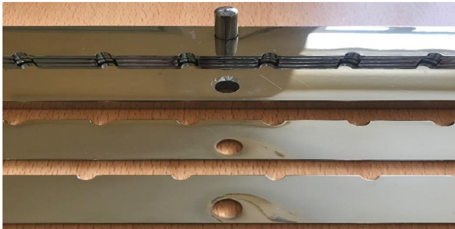
Şekil 3.11. Kalıba yerleştirilen 2. tabaka.
