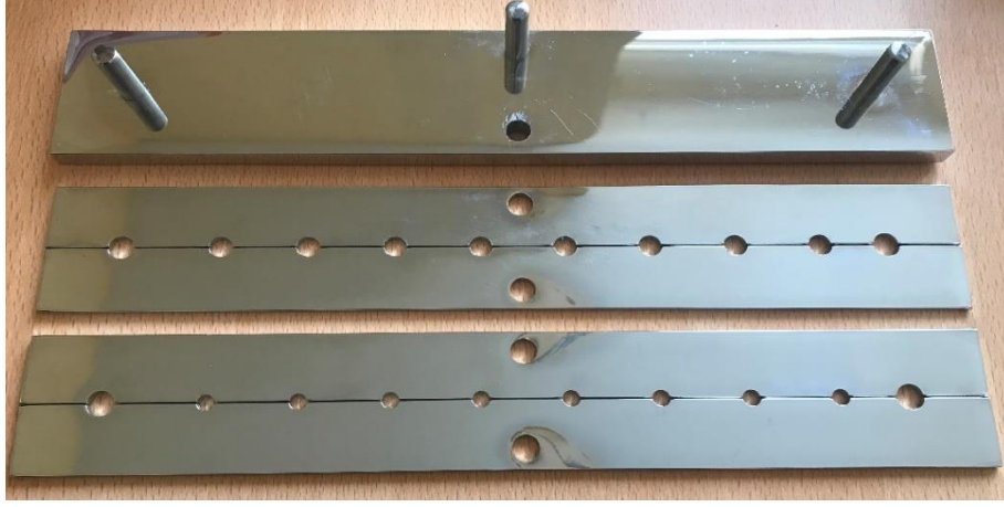
Şekil 3.9. Rezin uygulaması için üretilen kalıplar.
