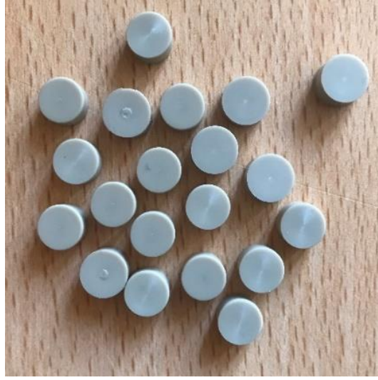
Şekil 3.1. Geçici PEEK örnekleri.
