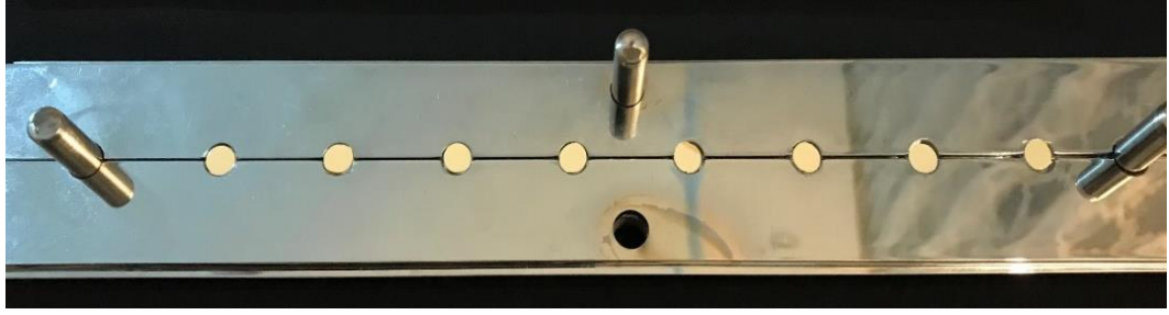
Şekil 3.15. Kalıpların alt kısmına yerleştirilen PEEK örnekler.
