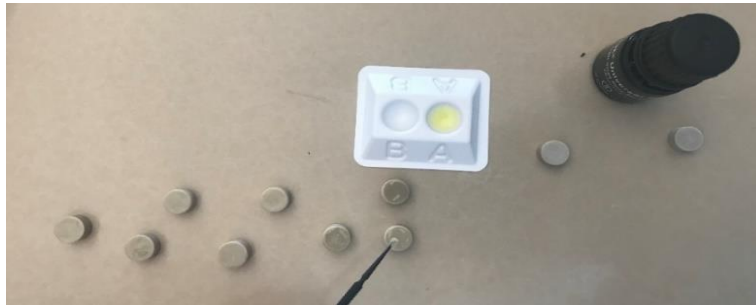
Şekil 3.14. Örneklere kompozit uygulamasından önce adeziv ajan uygulaması.
