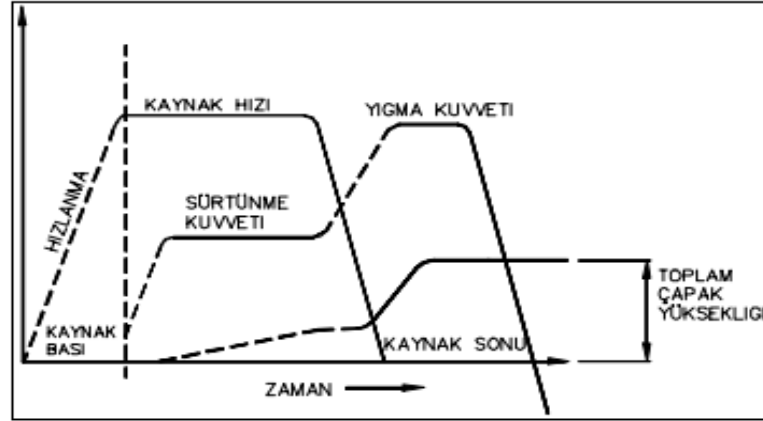
Şekil 3.7. Sürekli tahrikli sürtünme kaynağı özellikleri.
