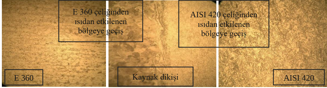
Şekil 6.3. D-2 numaralı deneye ait mikroyapı görüntüleri.
