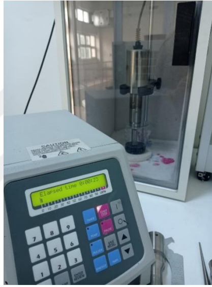
Şekil 5. 3. CNT/PVA Çözeltisine Uygulanan Sonikasyon İşlemi
