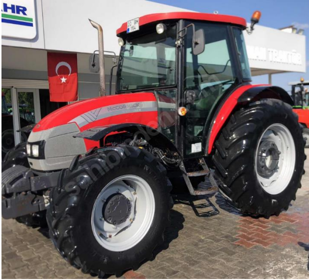
Marka McCormick Model Yılı 2012 Vites 12 İleri - 12 Geri Motor Gücü (hp) 105 Çekiş Tipi 4x4 Silindir Sayısı 4
