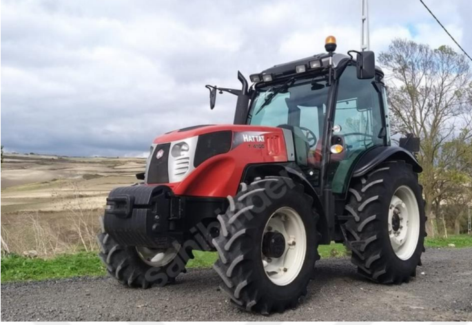
Marka Hattat Model Yılı 2015 Vites 24 İleri - 24 Geri Motor Gücü (hp) 102 Çekiş Tipi 4x4 Silindir Sayısı 4
