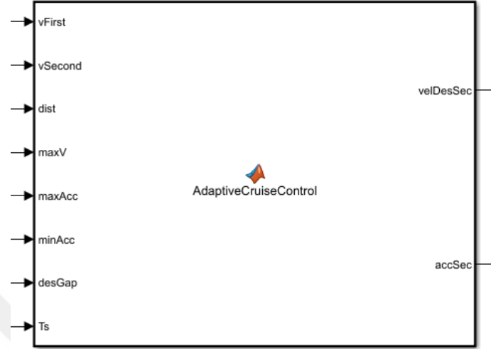
Şekil 4.10 Araçlar Arası Mesafe Kontrolü için Tasarlanan Kontrolcünün Simulink Modeli
