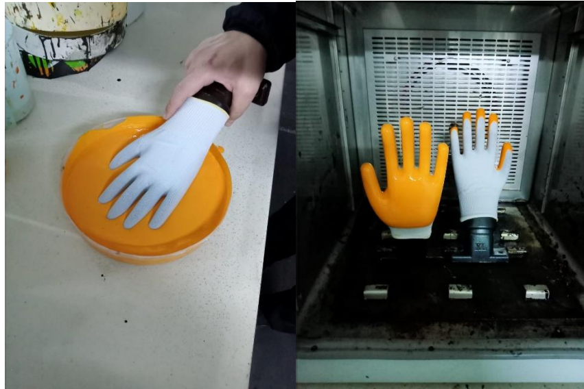
Şekil 4.5 : Eldiven daldırma ve kürlenme işlemi.
