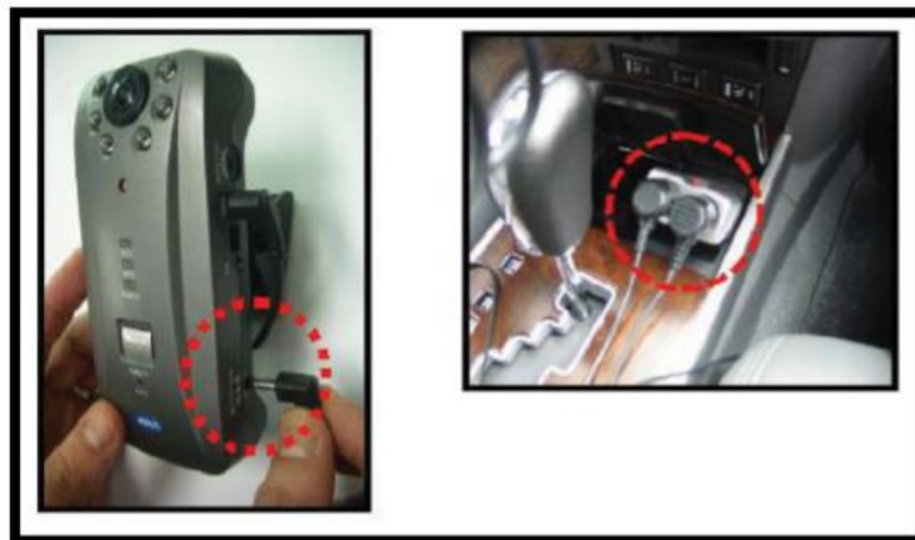
Şekil 6.10. Güç Kablosunun Kameraya ve Çakmak Prizine Bağlanması
