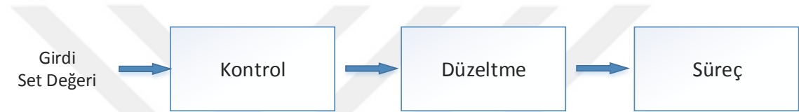
Şekil 2.16. Açık çevrim kontrol sistemi temel elemanları
