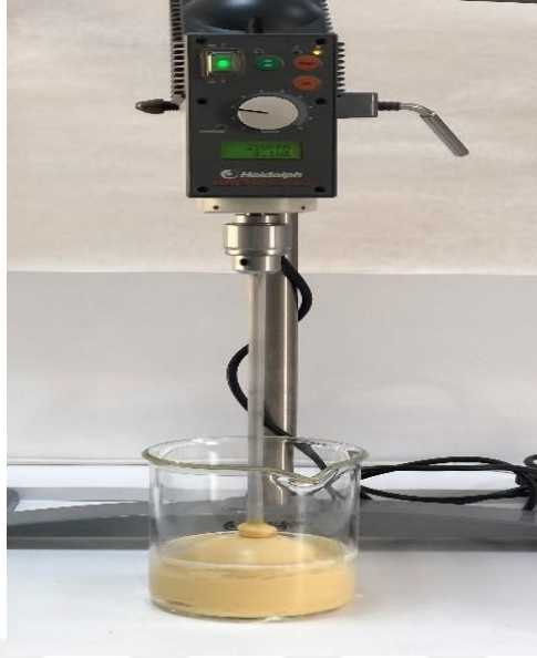
Şekil 3.6. MCM-41/Fe katalizör sentez sistemi.
