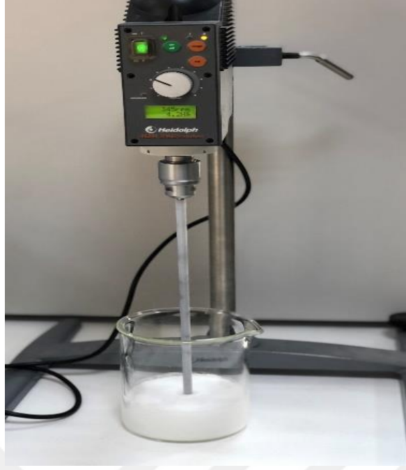
Şekil 3.3. MCM-41 katalizör sentez sistemi.
