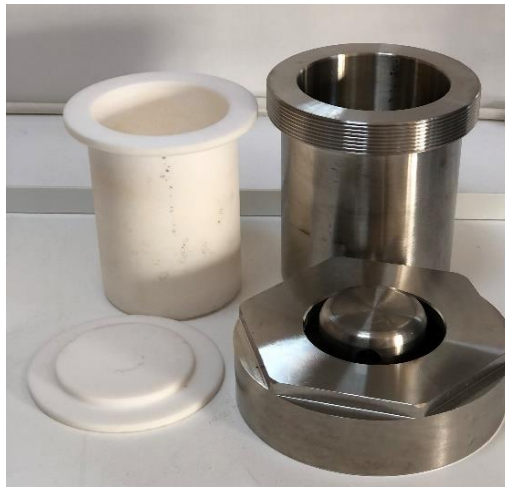
Şekil 3.4. Teflon kap ve hidrotermal reaktör.
