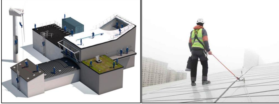
Şekil 3.3. Bina üzerinde dikey ve yatay yaşam hattı ile paraşüt tipi emniyet kemeri kullanımı
