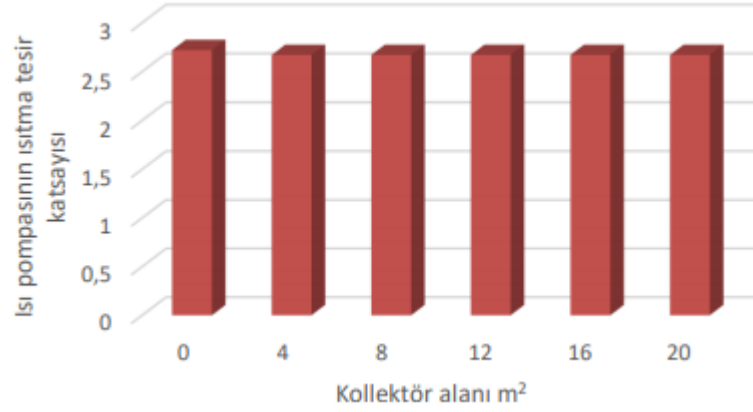
Şekil 5.12. 16.59 kW ısıtma gücünde ısı pompasının ısıtma tesir katsayısının kollektör alanına göre değişimi.
