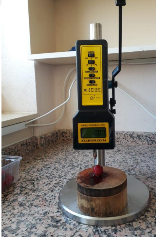
Şekil 3.6. Meyve eti sertliğinin ölçümü (orijinal)
