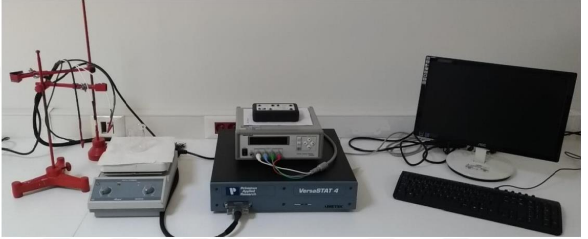
Şekil 3.2. Elektrokimyasal hücre, üç elektrotlu P/G cihazı, DAC-ADC cihazı ve bilgisayar
