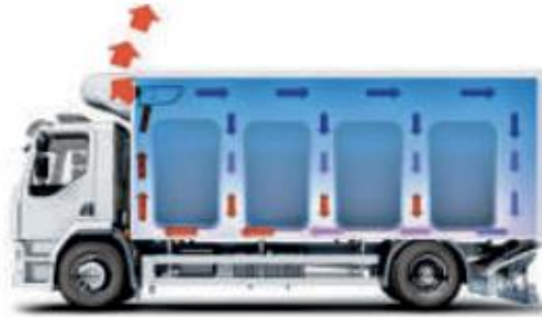
Şekil 5.12. Nakliye Araçlarında Havalandırma
