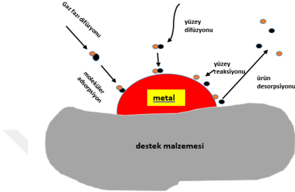
Şekil 2.5. Destek malzemesi ile modifiye edilmiş metal katalizör ile gerçekleşen ve gaz reaktanlara ait bir heterojen kataliz (URL_1 )
