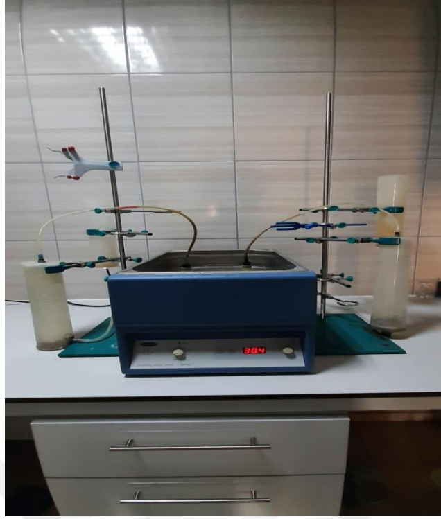
Şekil 3.2. \text{NaBH}_4 'ün hidrolizi sonucu açığa çıkan \text{H}_2 toplama düzeneği
