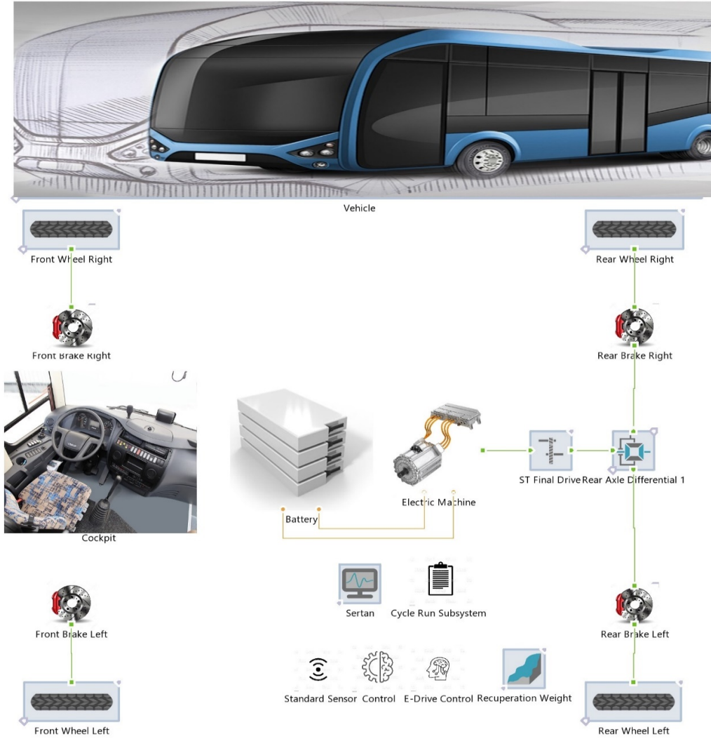
Şekil 3. 10. AVL Cruise M programında oluşturulan elektrikli otobüs modeli.
