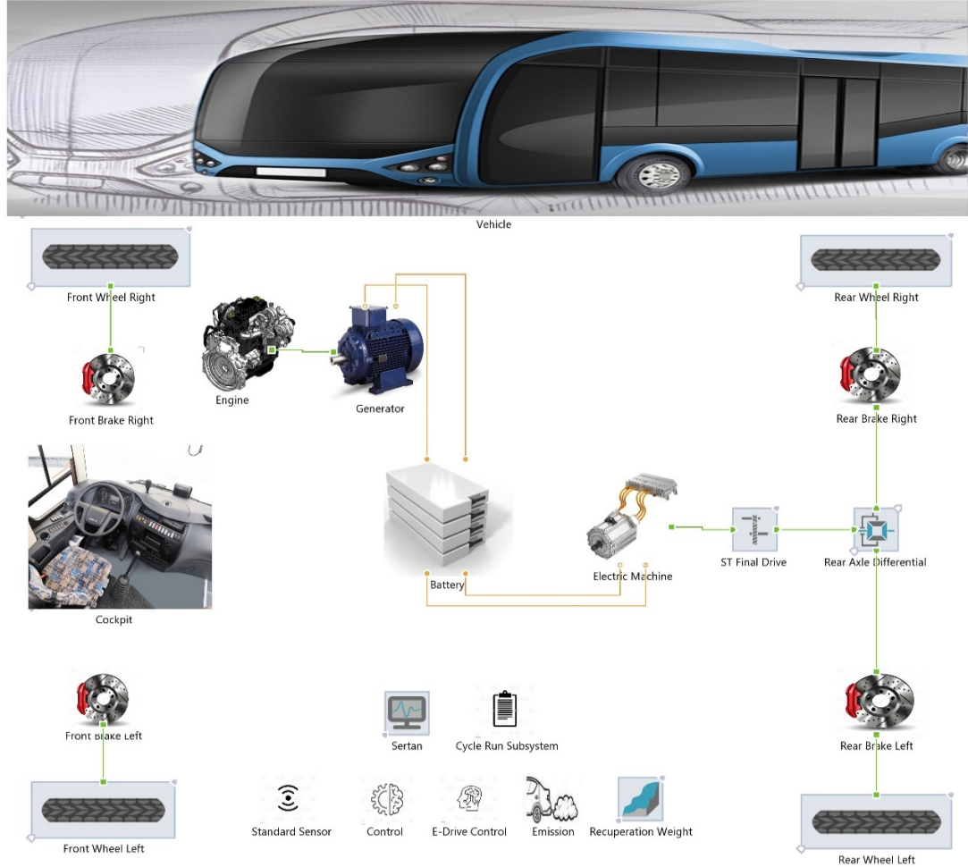
Şekil 3. 11. AVL Cruise M programında oluşturulan seri hibrit otobüs modeli.
