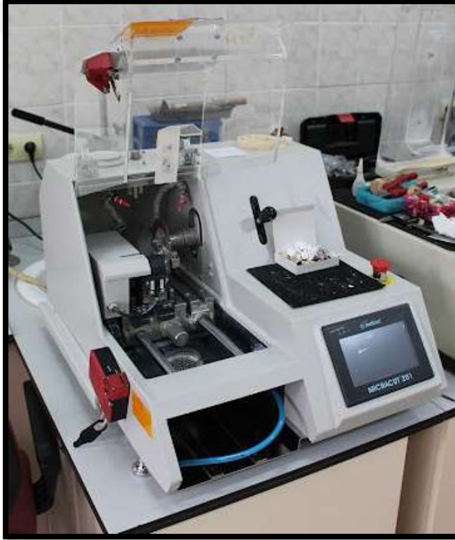
Resim 3.3. Araştırmada kullanılan hassas kesme cihazı
