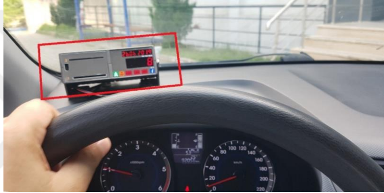
Şekil 4.3. Araca monte edilen takograf cihazı
