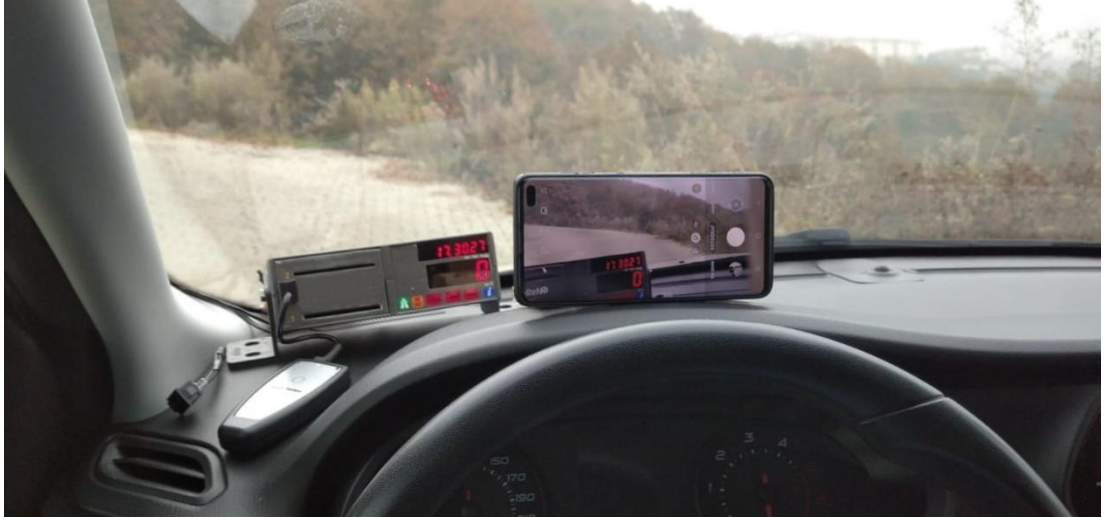
Şekil 5.9. Yolculukta takograf ekranı ve yolun kaydedildiği sistem
