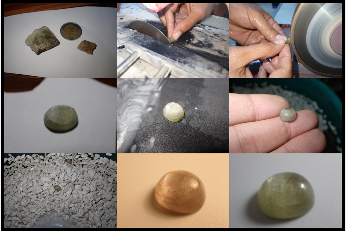
Şekil 5.15. Diasporun kabaşon şekillendirme aşamaları
