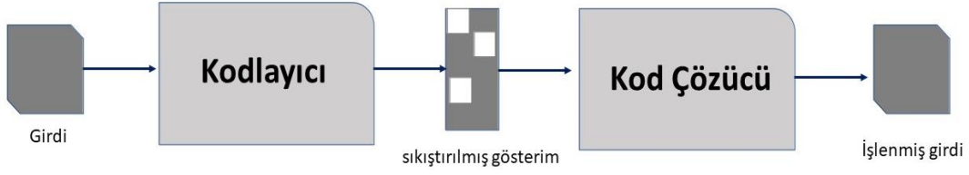
Şekil 3.1. Standart bir otomatik kodlayıcıya genel bakış.
