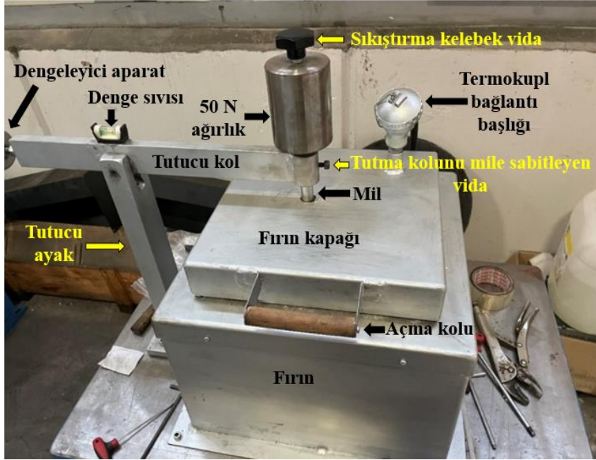
Şekil 3.28 Deney Seti Üzerinde, Teraziye Bağlanmış ve Sabitlenmiş Mil.
