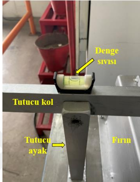
Şekil 3.29 Deney Seti, Hava İki Çizginin Arasında – Terazi Denge Durumunda.
