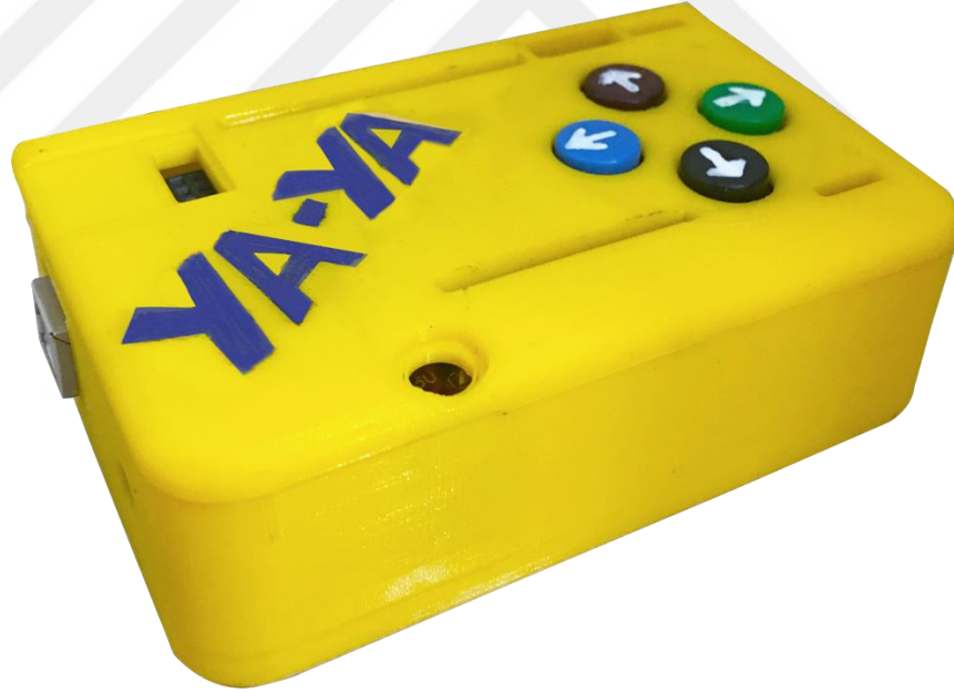
Şekil 10. Araştırma için özel olarak tasarlanmış 3B yazıcı çıktıtlı oyun konsolu
