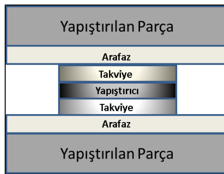
Şekil 3.1. Tipik bir yapıştırırmalı bağlantı.
