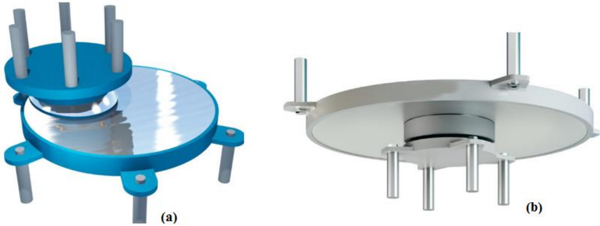
Şekil 6.18. Tek küresel yüzeyli sürtünmeli sarkaç tipi deprem izolatörler.
