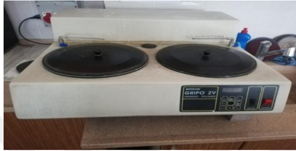
Resim 3.6 Zımpara ve Parlatma cihazı.
