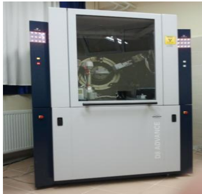
Resim 3.9 X-Işınları Difraksiyon Cihazı.
