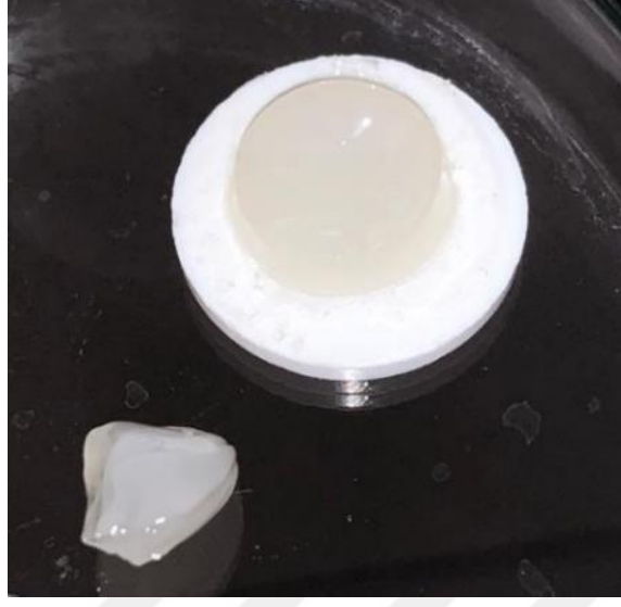
Şekil 4.8 Slip döküm yöntemiyle elde edilen ZIF-8 (Pm EG) ıslak monoliti dijital görseli
