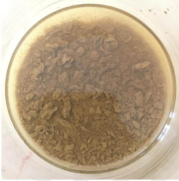
Şekil 33. Etil asetat'a döküldükten sonra lif benzeri yapının üstten görünümü (SPI1)
