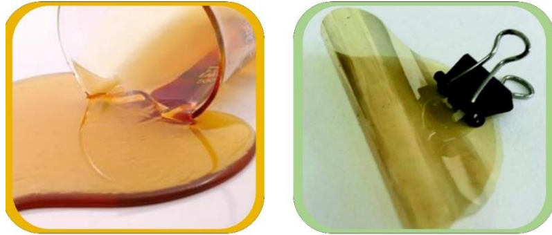
Şekil 22. Poliimid reçine ve film yapısı [114]
