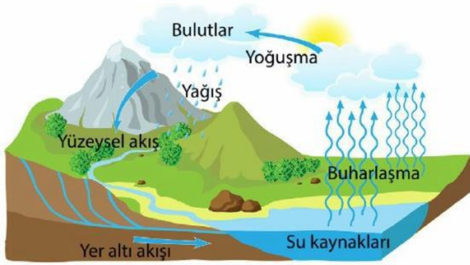
Şekil. 2.9. Yüzeysel akışının meydana gelişi (Anonim 2018)
