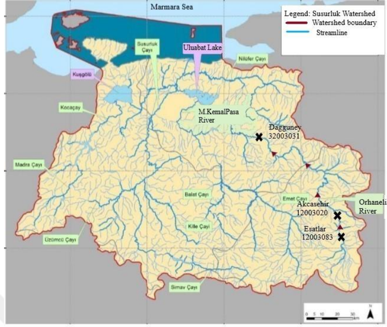
Şekil 3.1. Orhanlı Nehri ve nehir boyunca dere akışı izleme, nehir seviyesi ve yağmur ölçüm istasyonlarının konumu (Orman ve Su İşleri Bakanlığı 2018)
