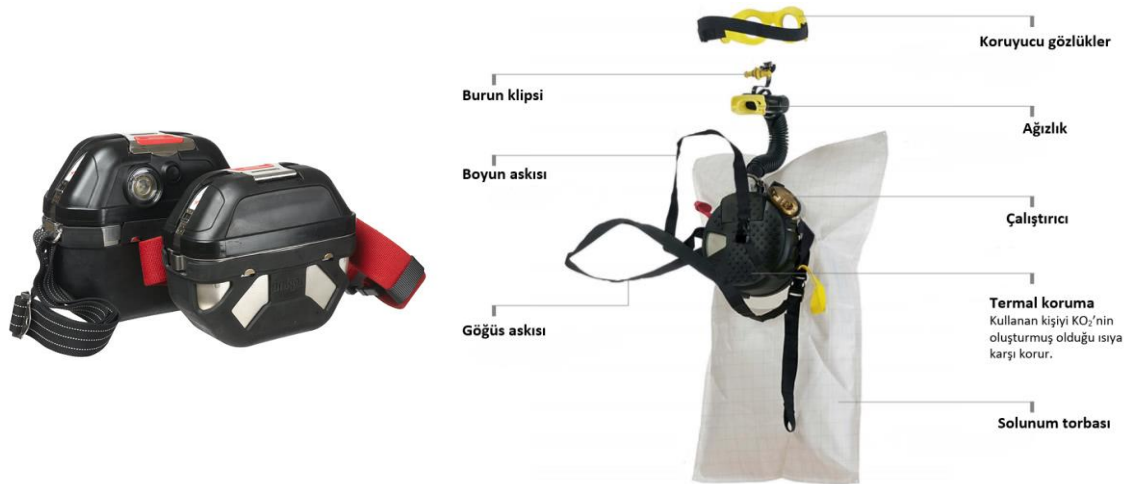
Şekil 2.8. Oksijenli tip ferdi kurtarıcı kapalı ve açık hali (66)
