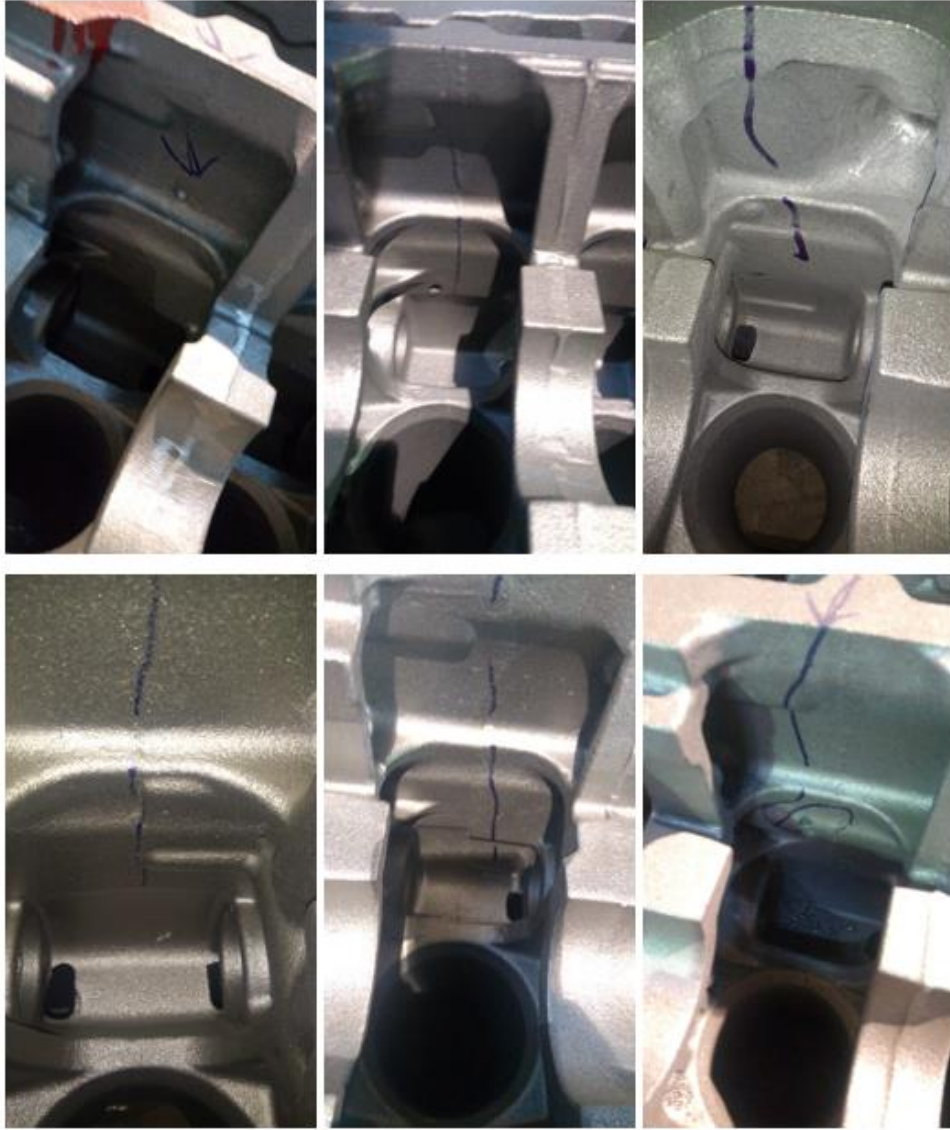
Şekil 3.1. Parçada tekrarlı olarak cüruf hatasının görüldüğü bölgeler
