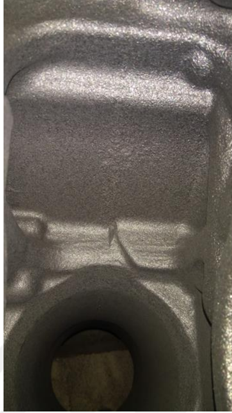
Şekil 3.6. Optimize yollukla dökülen parçalarda hatanın görülmemesi
