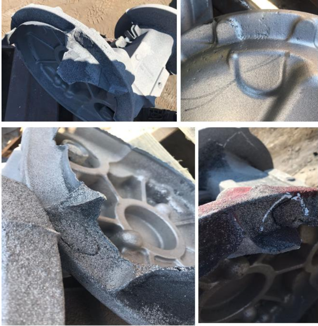
Şekil 3.16. Redüktör kovani parçasındaki dart hatası
