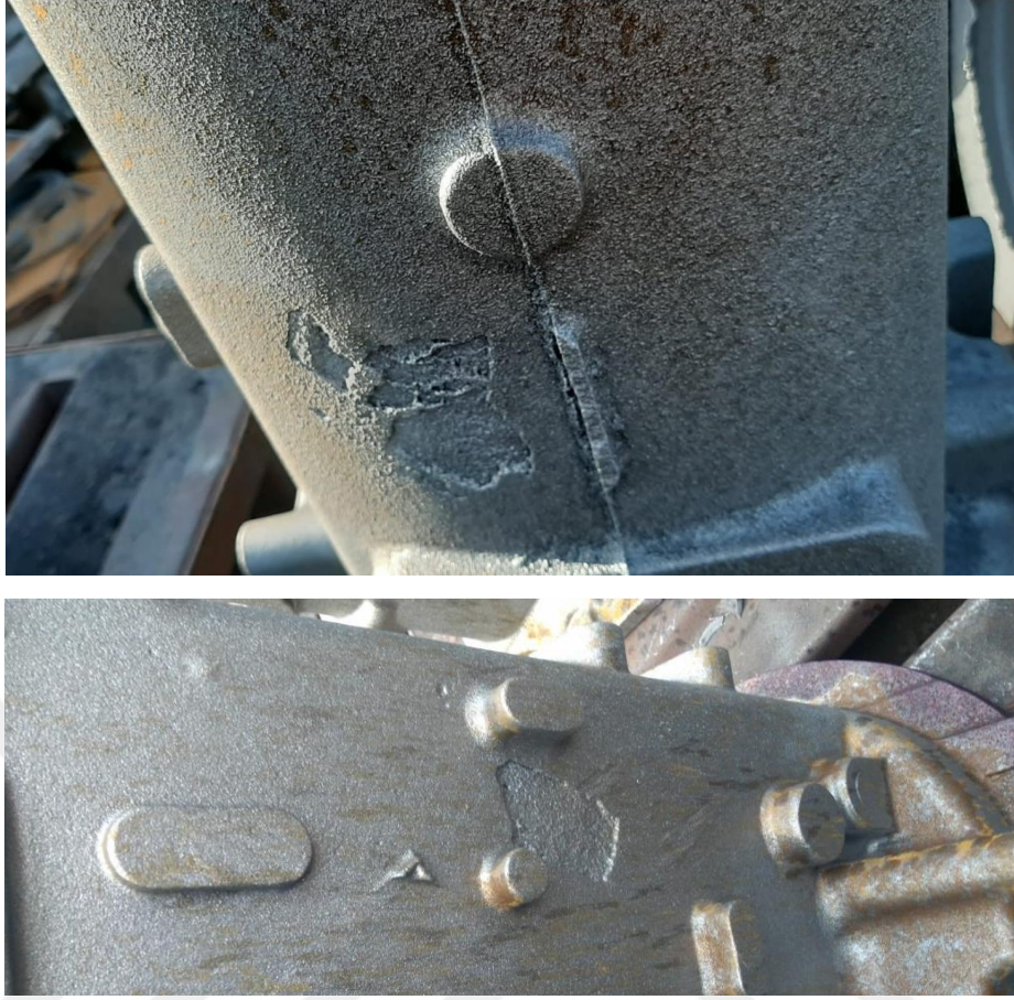
Şekil 3.7. Dişli kutusu parçasında görülen dart hatalarının örnekleri
