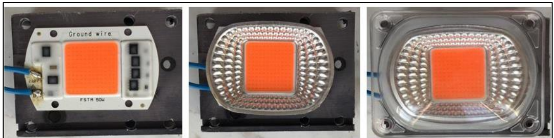
Şekil 3.29. Yapay ışık tasarımının montajı
