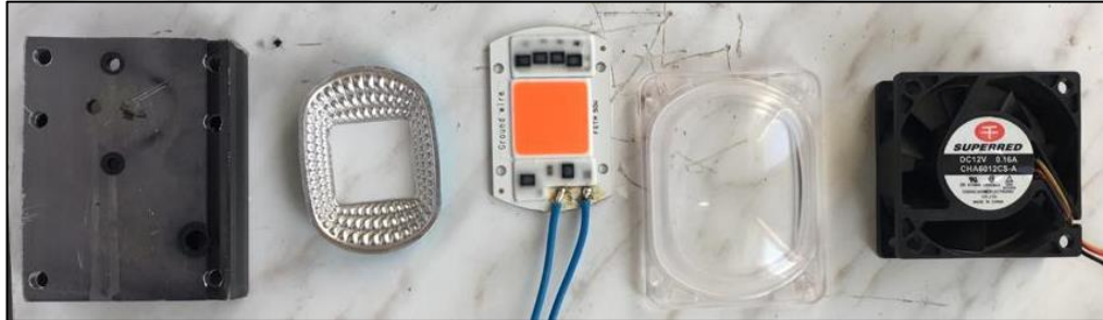
Şekil 3.28. Yapay ışık tasarımında kullanılan malzemeler
