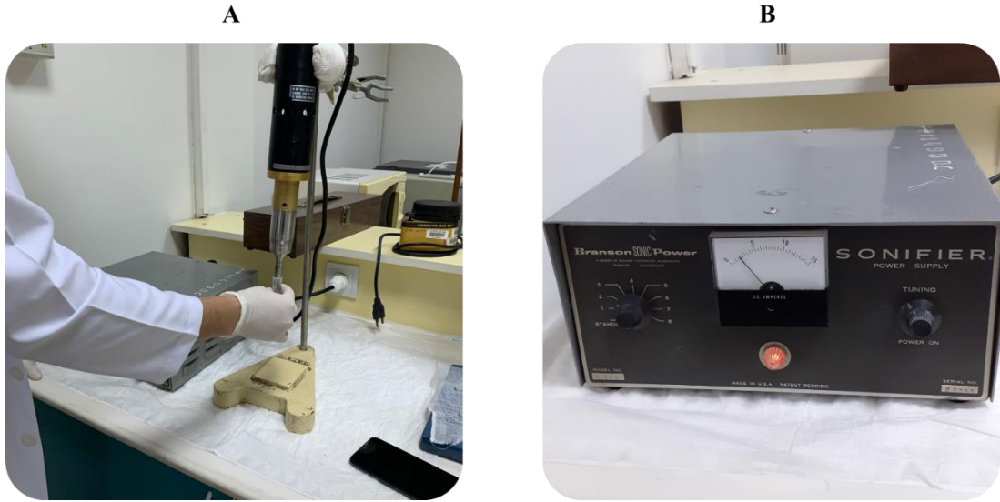
Şekil 28. Homojenizasyon işlemi. Şekil A. homojenizasyon işlemi, B. homojenizasyon işleminde kullanılan sonikatörü göstermektedir.
