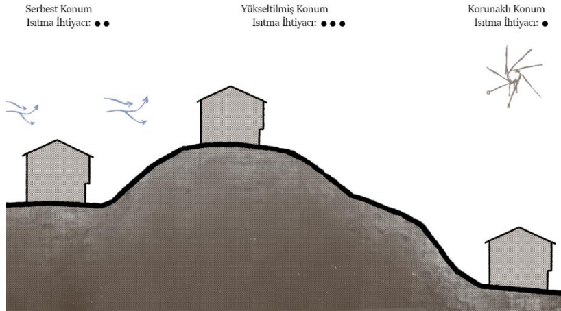
Şekil 2.2 : Topoğrafyaya bağlı değişkenlik gösteren ısıtma ihtiyacı (Akın, 2001’ den geliştirilerek).
