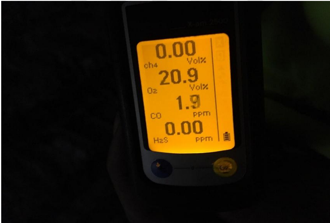
Şekil 5.7 Mithatpaşa-II Tünelinde Manuel Gaz Ölçüm Cihazı ile Diğer bir İlerleme Noktasındaki Gaz Ölçüm Değerleri.
