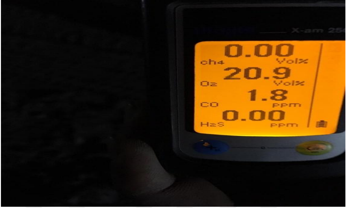
Şekil 5.8 Mithatpaşa-II Tünelinde Manuel Gaz Ölçüm Cihazı ile Başka bir İlerleme Noktasındaki Gaz Ölçüm Değerleri.
