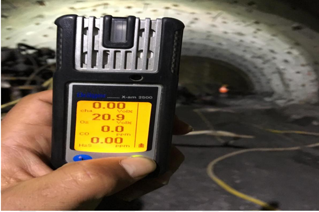
Şekil 5.6 Mithatpaşa-II Tünelinde Manuel Gaz Ölçüm Cihazı ile İlerleme Noktasındaki Gaz Ölçüm Değerleri.
