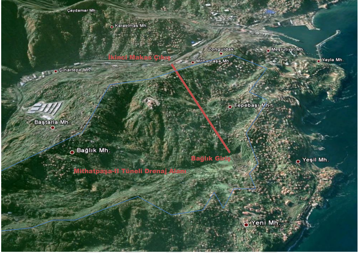
Şekil 3.17 Uydu Görüntüsünde Yüzey Sularının Drenajı ve Tünel Etkisi (Ölçeksiz).
