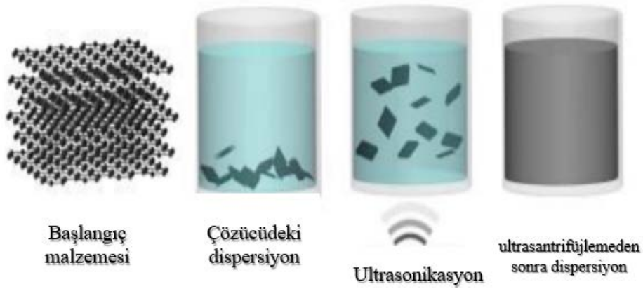
Şekil 1.8 : Sıvı faz eksfolasyon akış şeması [42].
