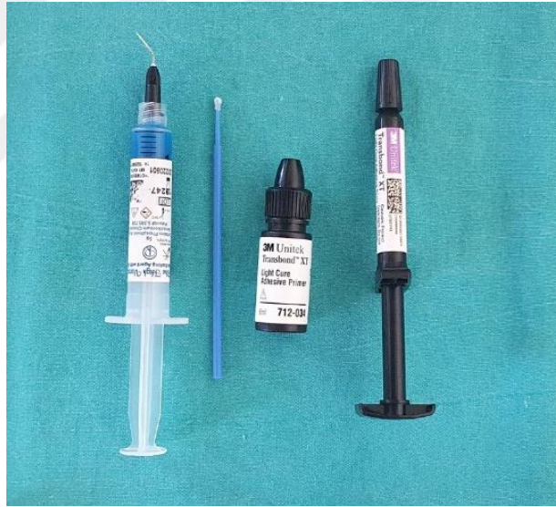
Şekil 3.15. Örneklere Uygulanan Ortofosforik Asit, Primer ve Kompozit
