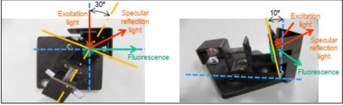
Şekil 3.1. Katı numune ölçüm standının tasarımı (Hitachi)
