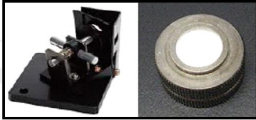
Şekil 3.1. Katı numune ölçüm standının tasarımı (Hitachi)
