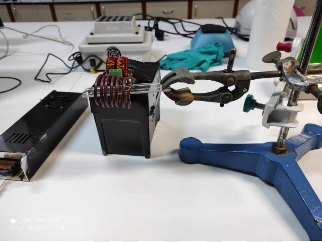
Şekil 4.10. Tasarlanan ve geliştirilen AMF sistemi 12 V dönüştürücü, AMF kaynağı ve 3 mm çapında bobinden 120 W güç kaynağından oluşmaktadır.
