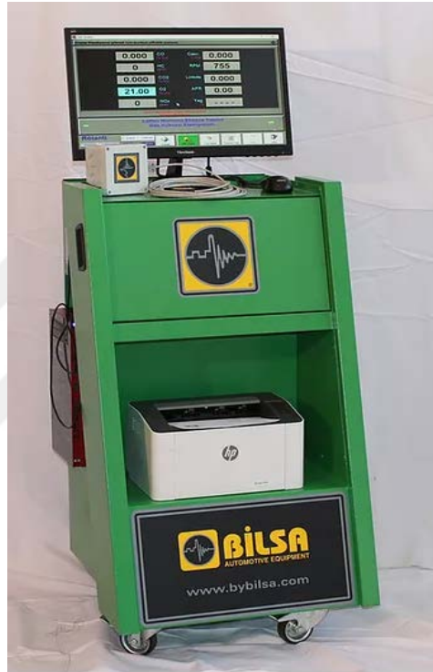
Şekil 5. Egzoz emisyon ölçüm cihazı
