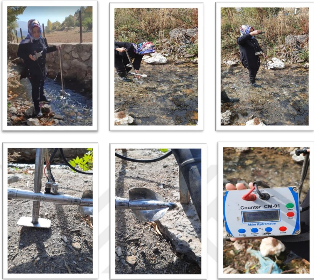
Şekil 2.3. Arazide debi ölçme çalışmaları ve ölçümde kullanılan muline metre
