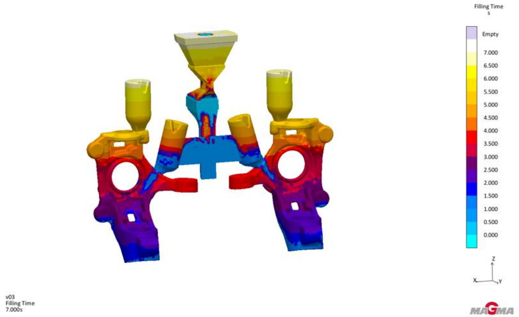
Şekil 3.10 Dökme demir akson dolum süresi analizi
