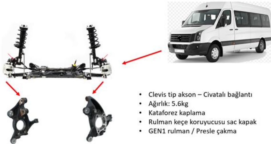
Şekil 2.6 Benchmark-2 akson detayları
