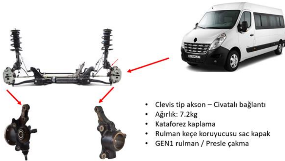
Şekil 2.7 Benchmark-3 akson detayları
