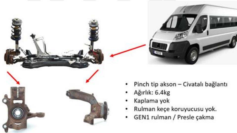
Şekil 2.8 Benchmark-4 akson detayları
