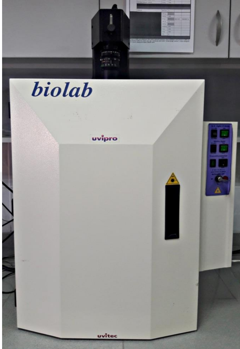
Şekil 3.12. UV altında ürünler için görüntüleme cihazı
