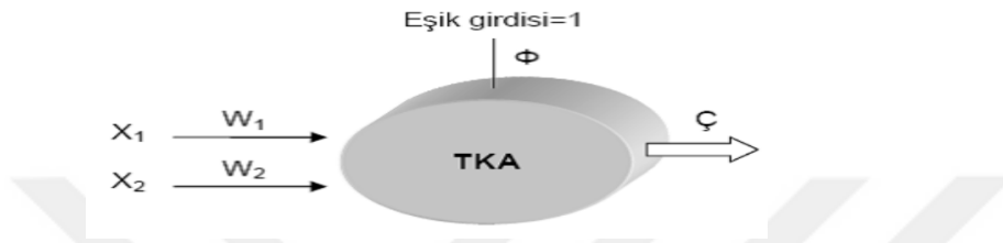
Şekil 7: Tek Katmanlı Yapay Sinir Ağının Yapısı
