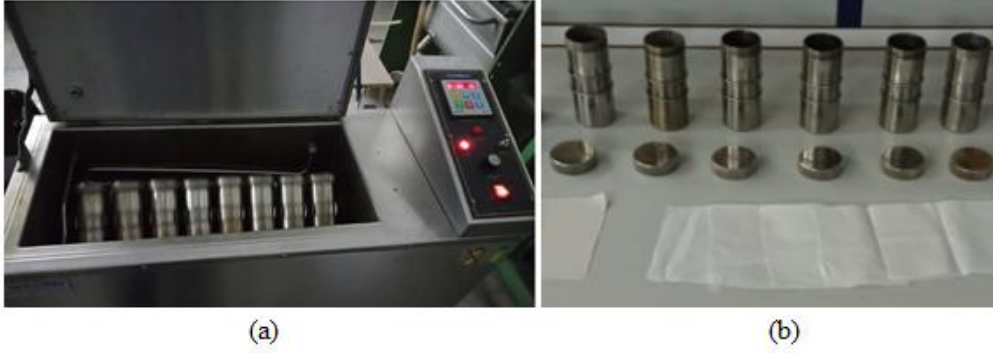
Şekil 3.13 (a) boyama makinesi (b) örnek kumaş boyama tüpleri
