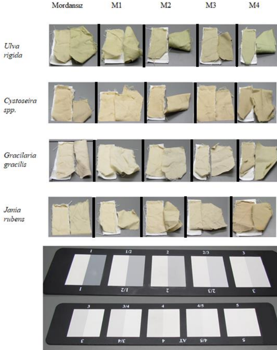
Şekil 4.37 Makroalglerle mordansız ve mordanlı boyanmış yünlü kumaşların yıkama haslı- ğının renk değişimi (solma) gri skala indeksi ile karşılaştırmalı görüntüleri. Birleştirilmiş her kare- nin sağ tarafında yıkama testine sokulmamış kumaşlar ile sol tarafta yıkama testine tabi tutulmuş kumaşların renk solmalarını gri skala (1(çok kötü), 1-2(kötü-çok kötü), 3(orta), 3-4(orta-oldukça iyi), 4(oldukça iyi), 4-5(iyi-çok iyi) ve 5(çok iyi)) ile değerlendirilmesi. M1: Potasyum alüminyum sülfat (şap, KAlSO_4 \cdot 10H_2O ), M2: Demir sülfat ( FeSO_4 \cdot 7H_2O ), M3: Potasyum dikromat ( K_2Cr_2O_7 ) ve M4: Bakır sülfat ( CuSO_4 \cdot 5H_2O )
