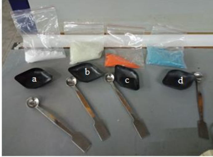
Şekil 3.16 Kumaş boyama işleminde kullanılan mordanlar a: (Potasyum alüminyum sülfat (şap), \text{KAlSO}_4 \cdot 10\text{H}_2\text{O} ), b: Demir sülfat ( \text{FeSO}_4 \cdot 7\text{H}_2\text{O} ), c: Potasyum dikromat ( \text{K}_2\text{Cr}_2\text{O}_7 ) ve d: Bakır sülfat ( \text{CuSO}_4 \cdot 5\text{H}_2\text{O} )
