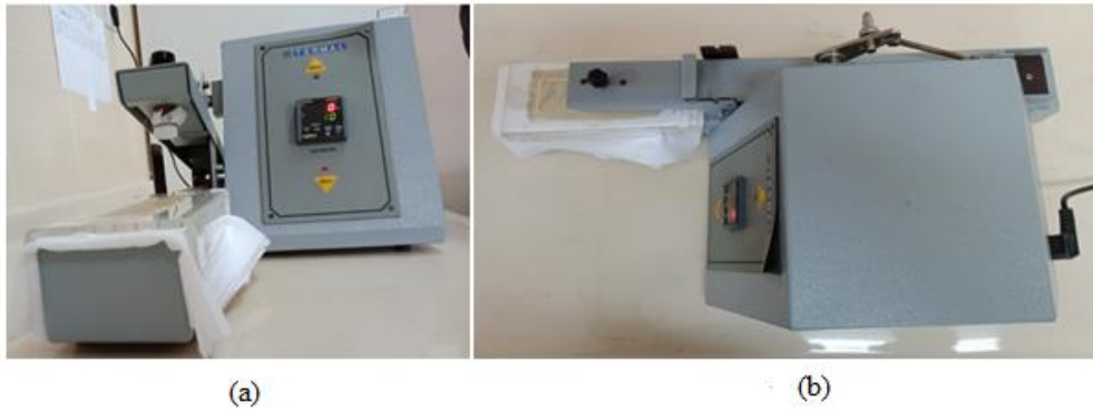
Şekil 3.22 (a) Kumařa s rtme haslığı testinin uygulanması ( nden g r n ř) (b)S rtme testi esnasında s rtme biriminin  stten g r n ř 
