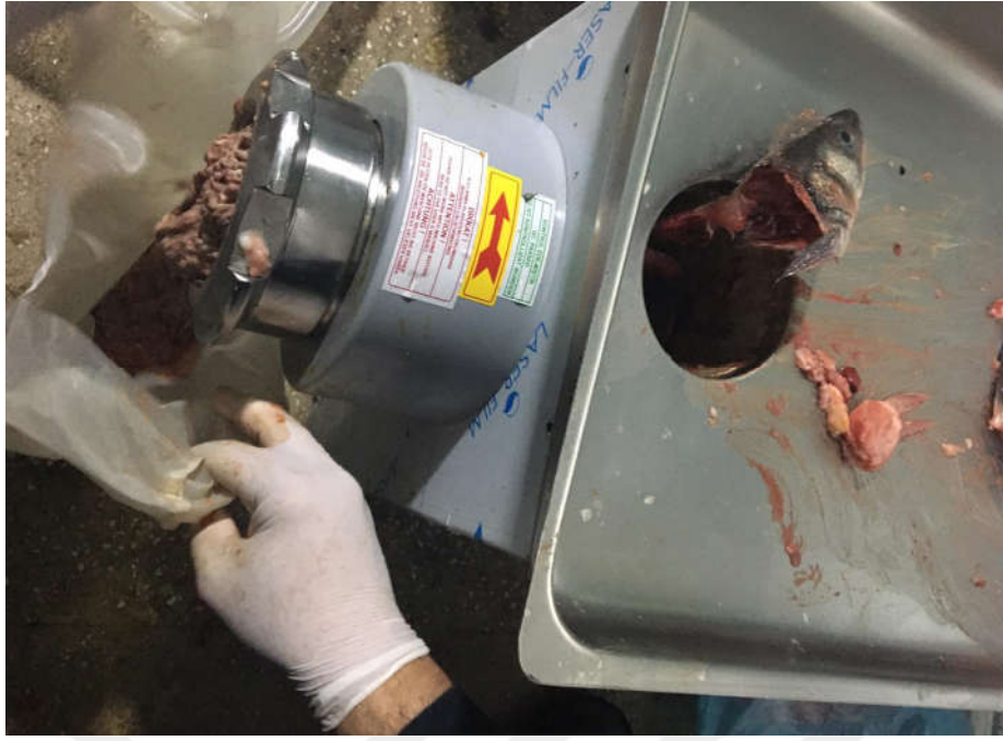
Şekil 2. Balık atıklarının soğutmalı kıyma makinesinden geçirilmesi
